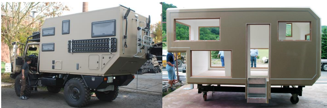
Abbildung 3 Caravanaufbau am Beispiel links Unimog (Individualausbau JOKO Wohnmobil [3]) rechts Offroad-Wohnkabine (Moser Fahrzeugsonderbau [4])
